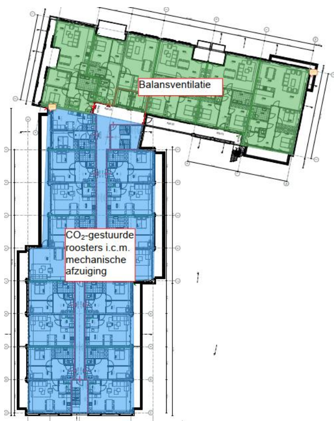
Figuur 2.6: Ventilatieprincipe per bouwdeel
